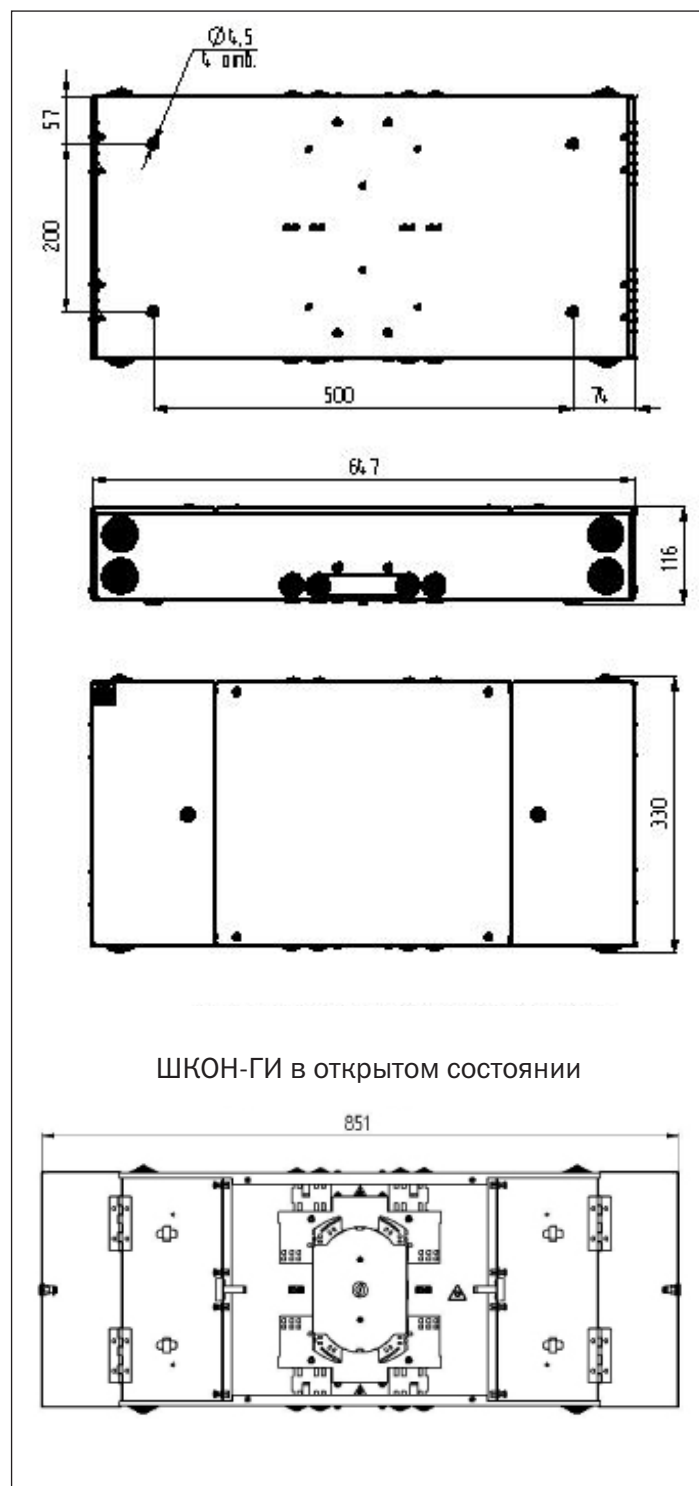
Рисунок 3.1 - Габаритные и установочные размеры шкафа
