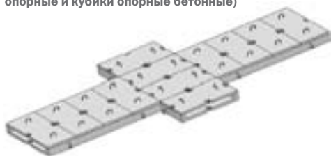
Лоток экранированный разветвительный на четыре направления большой в сборе (на проходных лотках - крышки КЭБ, на разветвительном – крышки КЭУ, крышки КЭУ опираются на стальные полосы опорные и кубики опорные бетонные)
