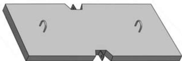
5. Крышка экранированная для проходного лотка большого.
