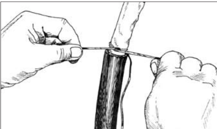
Рис. 3.1 - Бандаж на поясной изоляции
