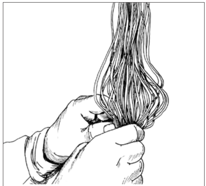
Рис. 3.4 - Распушивание сердечника кабеля
