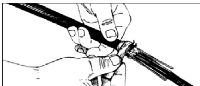
Рисунок 4.35 – Наложение бандажа из проволоки
