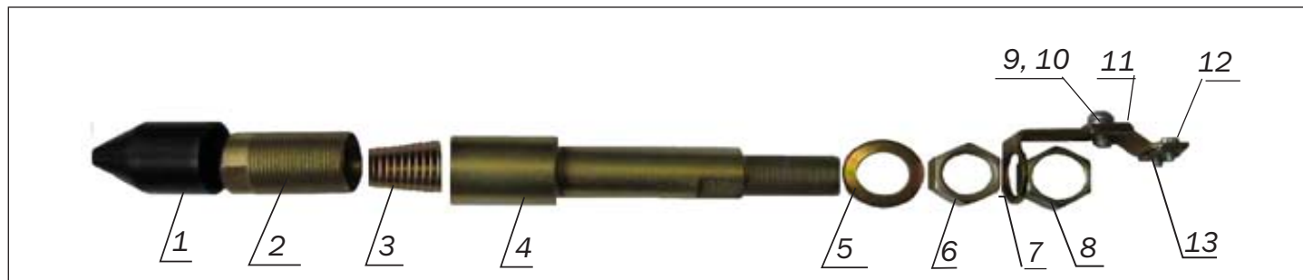
1 – Наконечник; 2 – Гайка внутренняя; 3 – Конус внутренний; 4 – Штуцер; 5 – Шайба; 6,8 – Гайка М18; 7 – Кронштейн; 9,10 – Винт М5 с шайбой; 11 – Скоба; 12 – Пластина; 13 – Винт (2 шт.);
