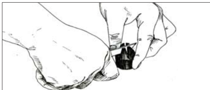
Рисунок 4.13 - Прорезание конусного участка наконечника штуцера
