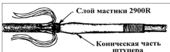
Рисунок 4.3 – Установка штуцера на внутреннюю оболочку ОК
