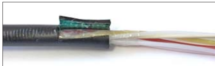
Рисунок 4.12 - Отогнутый участок оболочки вместе с алюминиевой лентой
