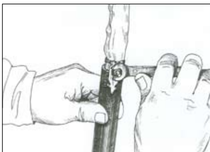
Рисунок 4.2 – Установка соединителя экрана Scotchlok 4460-D
