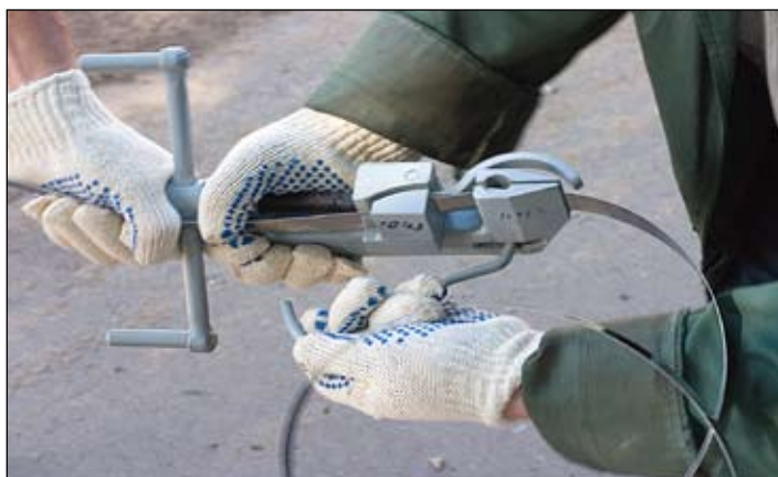
Рис. 4.2. Отрезка длины монтажной ленты с помощью клещей натяжных
