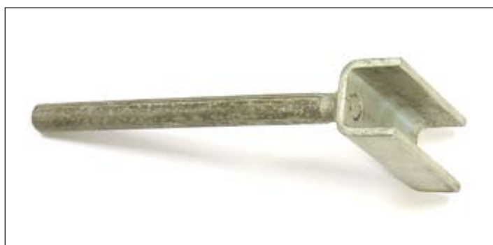
Рисунок 4.7 – Специальный ключ S=24 мм (а), свинчивание шуцера и втулки с его помощью (б)
