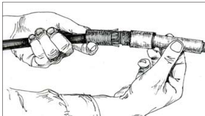
Рисунок 4.6 – Установка шуцера на втулку с наружной резьбой
