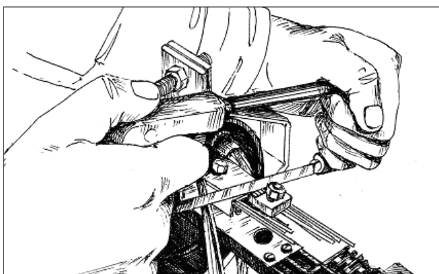
Рис. 3.9. Закрепление и обрезка проволок брони
