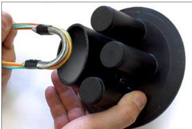
Рис. 3.7. Ввод транзитной петли в овальный патрубок с помощью специального приспособления представляющего собой оправку с плавным изгибом. Пучок модулей закреплён на приспособлении банджами из липкой ПВХ ленты.
