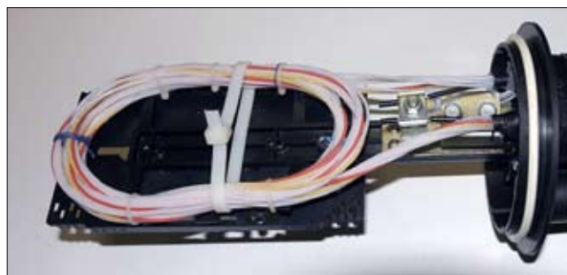
б – транзитная петля кабеля ёмкостью до 192 волокон, такой вариант используется если количество сращиваемых волокон не превышает 24-х.
