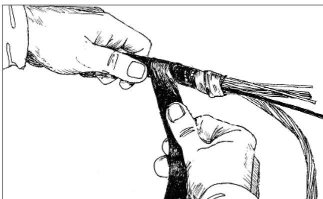
Рис. 3.8. Намотка ленты 88Т на место продольной герметизации кабеля в муфте
