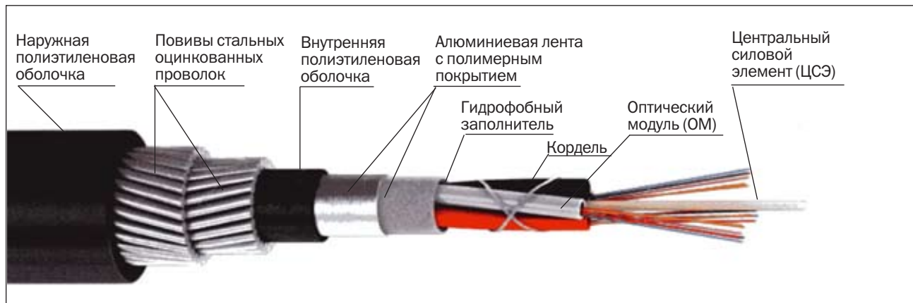
Рисунок 14 – ОК с броней из двух повивов стальных оцинкованных проволок
