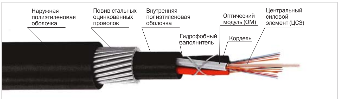
Рисунок 13 – ОК с броней из повива стальных оцинкованных проволок
