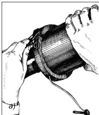
Рисунок 6.1. – Стягивание хомута, фиксация его защелкой (а) и установка фиксатора (б)
