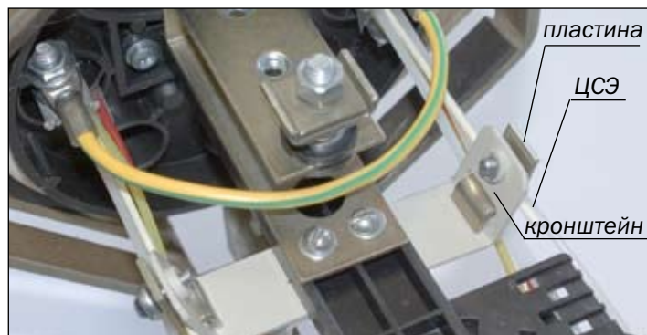
Рисунок 5.2 – Крепление ЦСЭ ОК, вводимых в цилиндрические патрубки
