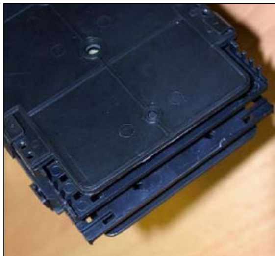
Рисунок 5.5 – Крепление кассет на кронштейне
