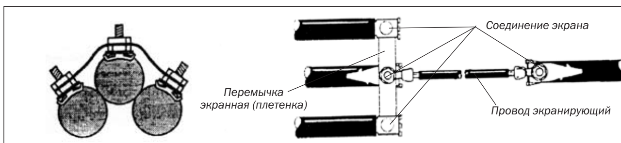
Рисунок 3.22 – Схема соединения экрана с разветвлением кабеля на три направления
