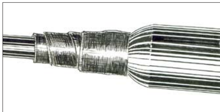
Рисунок 3.9 – Конусная часть муфты с намотанной лентой VM
