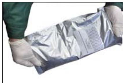
Рисунок 3.13 – Смешивание компонентов герметика
