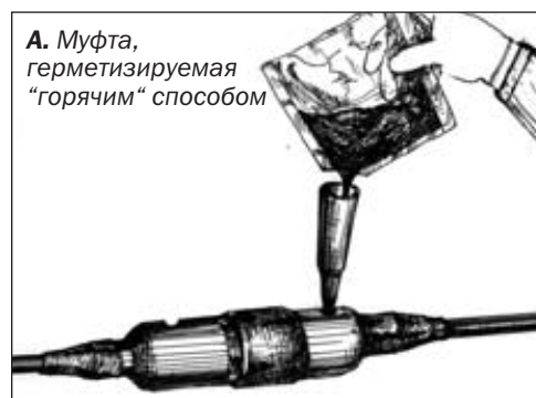
Рисунок 3.14 – Заливка герметика в муфты
