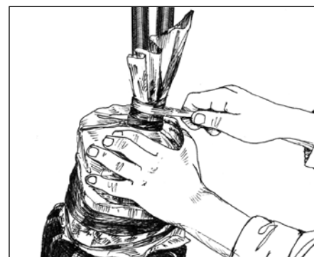
Рис. 3.6. Обмотка полиэтиленового рукава на кабелях ПВХ лентой
