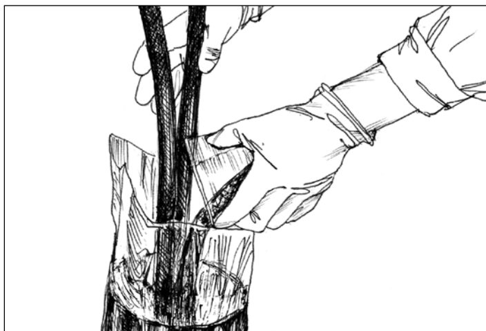
Рис. 3.5. Заливка герметика ВИЛАД-31 в горловину муфты МПЗ
