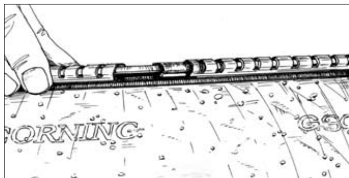
Рисунок 4.6 - Надвигание застежек на пластиковые направляющие манжеты и на стопорный хомут
