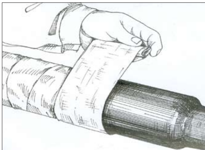
Рисунок 4.1 - Обмотка муфты кабельной бумагой
