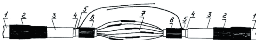
Рис. 3. Наложение мастики МГ-14-16 перед закреплением пакета: 1 – покров типа «Шп»; 2 – ТУТ продольной герметизации; 3 – алюминиевая оболочка; 4 – ленты кабельной бумаги; 5 – контрольная жила; 6 – мастика МГ-14-16; 7 – сростки жил, изолированные гильзами из трубок ТУТ
