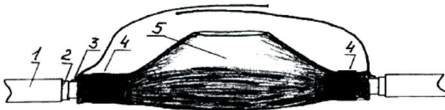
Рис. 4. Пакет из плёнки перед заливкой геля 8882: 1 – алюминиевая оболочка; 2 – ленты кабельной бумаги; 3 – контрольная жила; 4 – бандаж из ленты 88Т; 5 – пакет
