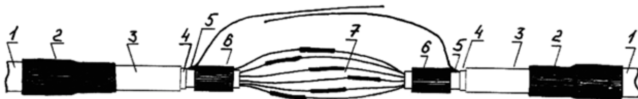
Рис. 3. Наложение мастики МГ-14-16 перед закреплением пакета: 1 – наружная оболочка; 2 – ТУТ продольной герметизации; 3 – алюминиевая оболочка; 4 – ленты кабельной бумаги; 5 – контрольная жила; 6 – мастика МГ-14-16; 7 – сростки жил, изолированные гильзами из трубок ТУТ.
