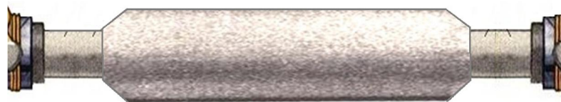
Рис. 11. Конусы муфты сформированы.
