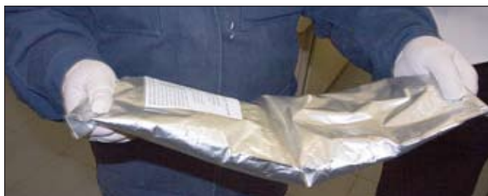
Рисунок 4.2 – Смешивание компонентов герметика в пакете
