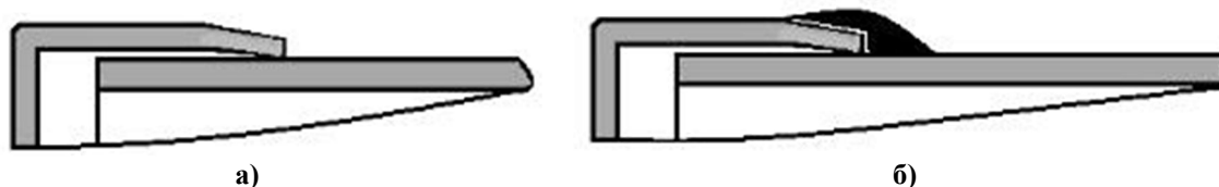
Рис. 5. Форма шва на стыке оголовника и корпуса МСР. Припой закрасен чёрным цветом: а – до наложения припоя; б – сформированный и разглаженный паяный шов.
