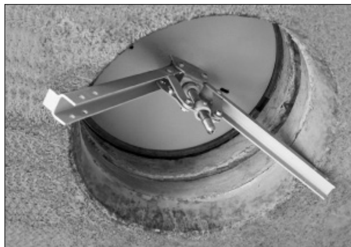
Рисунок 4.2 – Блокировка рычагов УЗНКЛ относительно конструктивных элементов колодца
