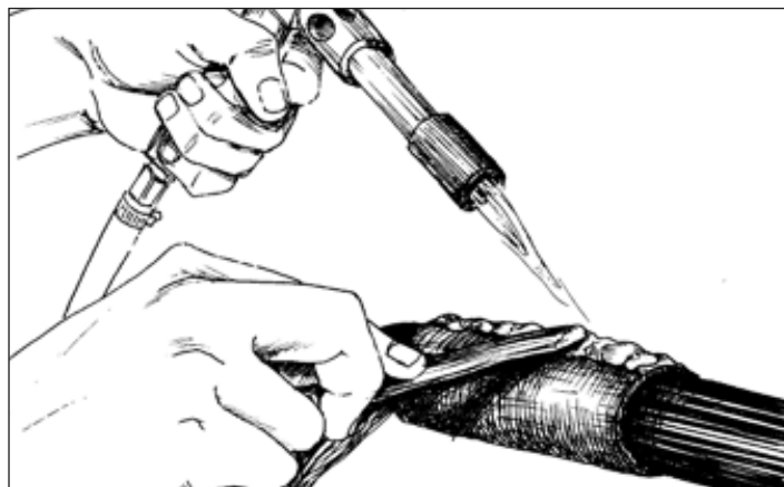
Рис. 3.4 - Запайка продольного разреза свинцовой втулки
