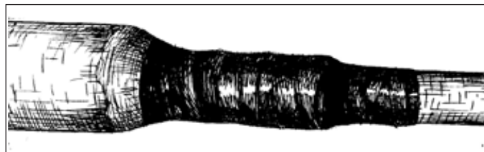
Рис. 4.3 - Отремонтированная манжета МПК-ПС первым «горячим» способом с применением клея-расплава и термоусаживаемой ленты «Радлен»
