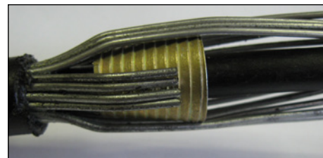
5.3 Обрезать проволоки по окружности на расстоянии 2/3 длины конуса.
