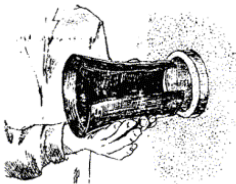
Рис. 4.11. Установка воронки в трубу канала
