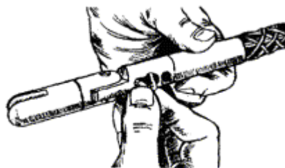
Рис. 4.13. Установка наконечника с чулком и компенсатором кручения на конце кабеля
