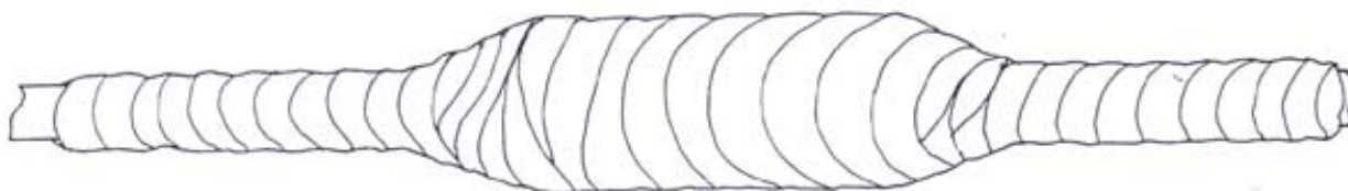
Рис. 7. Муфта МПВ-А-ТУМ обмотанная влагоотверждаемым бинтом «Армопласт», который должен перекрывать наружную манжету не менее чем на 30 мм по обе стороны от её краёв.
