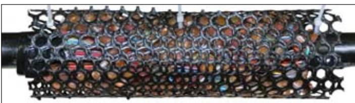
Рисунок 3.6 – Скрепленная на сrostке сетка
