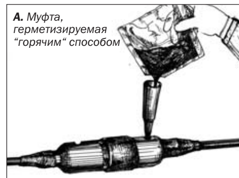
Рисунок 3.14 – Заливка герметика в муфты
