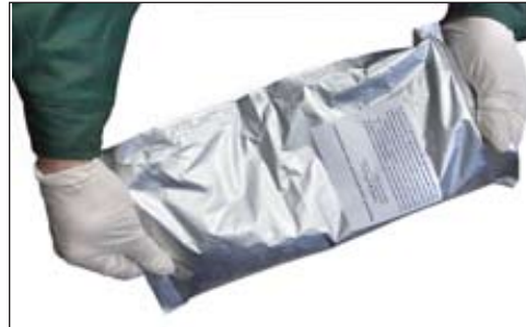
Рисунок 3.13 – Смешивание компонентов герметика
