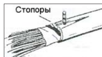
Рисунок 3.2 – Установка основания соединителя 4462
