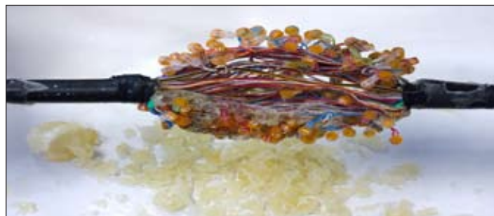
Рисунок 4.4 – Сросток после полного скрошивания герметика
