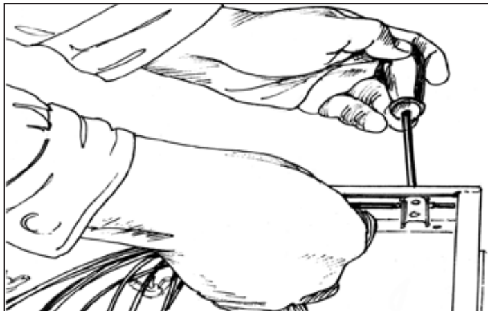
Рис. 3.6. Крепление ЦСЭ к шкафу
