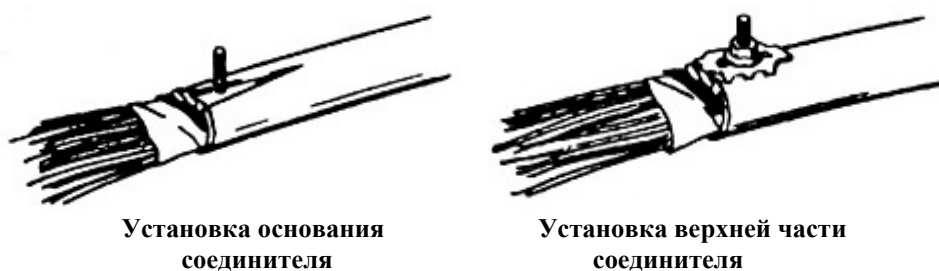
Рис. 2. Установка соединителя экрана 4462.
