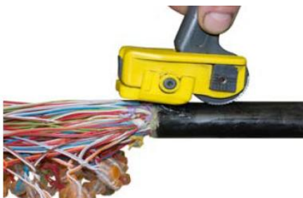
Рис. 2.Выполнение разрезов оболочки ножом KMS-K.
