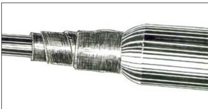
Рис. 18. Конусная часть муфты МГПг с намотанной лентой VM.
