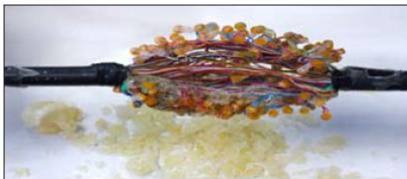
Рис. 17. Внешний вид сростка после удаления герметика.
