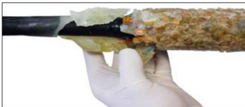
Рис. 16. Удаление герметика с участка оболочки, находившегося внутри корпуса муфты.
