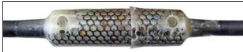
Рис. 14. Сросток МГПг после снятия полумуфт.
